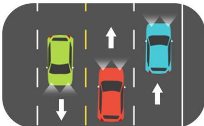
6. **Pada jalur jalan menggunakan markah warna putih untuk memisahkan jalur jalan yang searah, dengan markah warna kuning untuk memisahkan jalur jalan arah berlawanan.**
